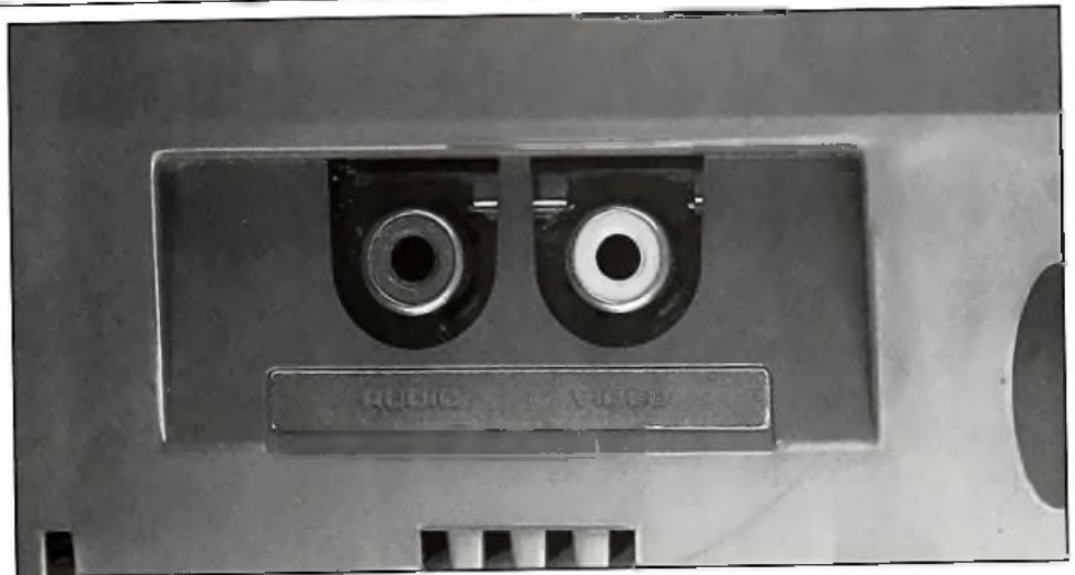
Connecter le Nintendo Entertainment System à une chaîne haute fidélité est possible par l'intermédiaire de la sortie audio.
