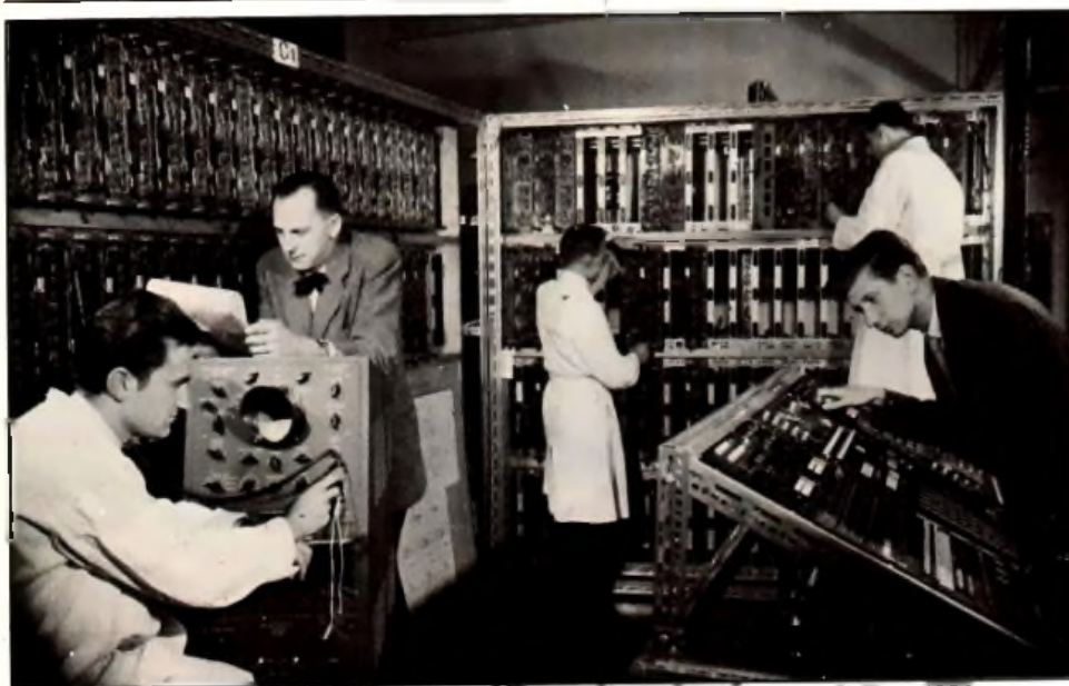
Ordinateur à calcul parallèle et mémoire à tambour construit en 1956 par l'Office national d'études et de recherches aérospatiales (ONERA).
